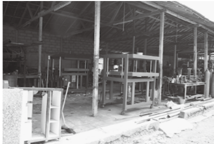
細かく砕いたプラスチック粉をプレートの上に慣らして並べ、圧縮し熱で溶解して固め、加工用のプレートを作成する
