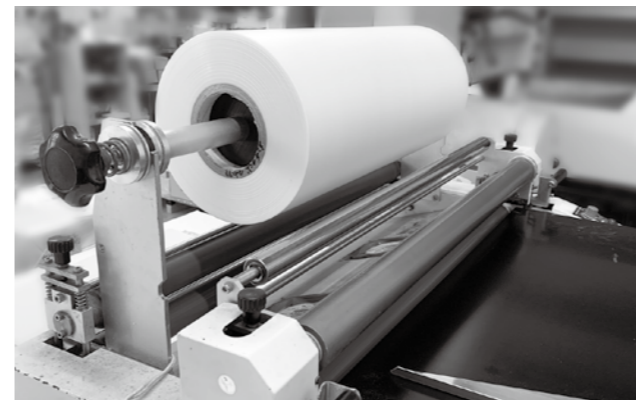
卓上のPP加工機 1メートル四方のスペースで設置可能
