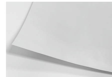
テンションによってはPP加工時の紙がカールする
