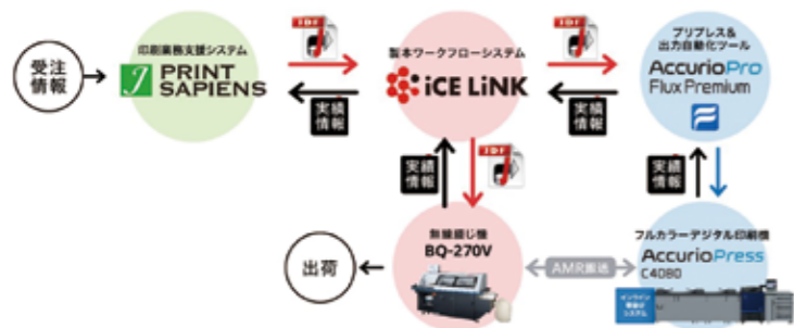
【JDF連携により従来多くの時間を要していた印刷工程の自動化を実現】(図2)
