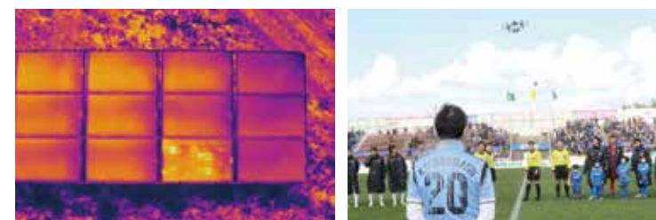
左) 赤外線センサーで太陽光パネルを点検 不良部分が一目でわかる 右) Jリーグ公式戦でドローンボールトスを行った
