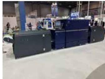
[8h] コニカミノルタのトナー方式のラベル印刷システム AccurioLabel 400
