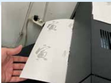
オンデマンド加飾機でトナーの上に金箔加工を施す
