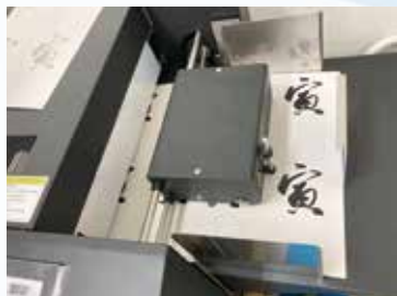
オンデマンド加飾機でトナーの上に金箔加工を施す
