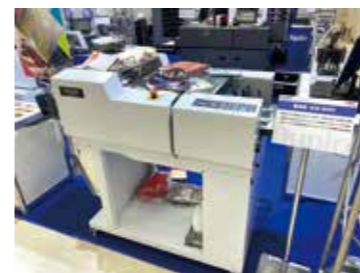
デュプロは印刷済み用紙をオンデマンドで封筒製袋するシステムを出展
