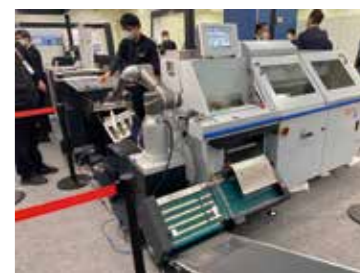
ホリゾンと理想科学工業のインライン接続による製本システムライン
