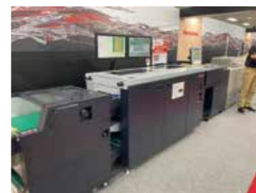
ホリゾンとリコージャパンのインライン接続によるカットシステムライン
