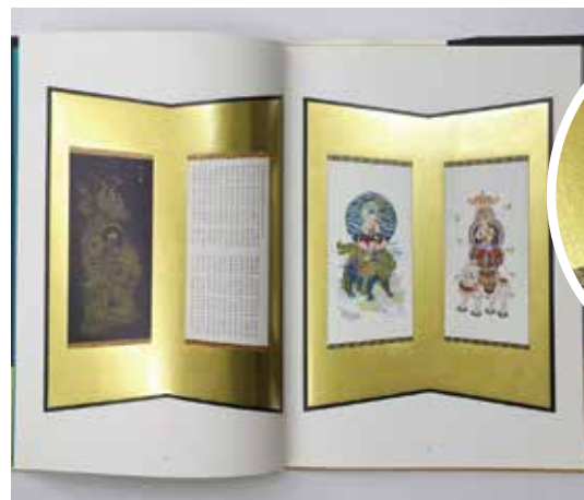
金屏風部分にマイクロエンボス加工の金箔押しを施した(円内)
