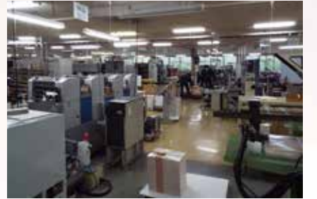
照明はLED オフセット印刷機はすべてLED-UV 機 工場全体が無臭・ノンパウダー オゾンが発生しないのでダクトもない
