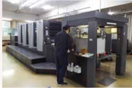
照明はLED オフセット印刷機はすべてLED-UV 機 工場全体が無臭・ノンパウダー オゾンが発生しないのでダクトもない
