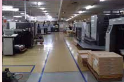
照明はLED オフセット印刷機はすべてLED-UV 機 工場全体が無臭・ノンパウダー オゾンが発生しないのでダクトもない
