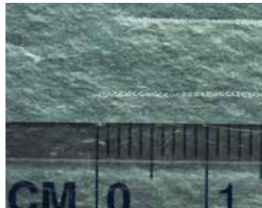
⑦ 上：ネオサイクロスタイルスタイラス による製版 下：A.B. ディック社 ルーレット状の スタイラスによる製版
