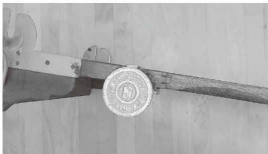
⑦印象的な中央部分の台座ノブを回すと 刷り台面が、前後に移動する
