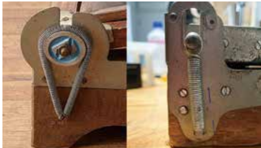
④バネによるヒンジの形状の一例 跳ね上げ式の形状を合わせるとまだ複数種あり
