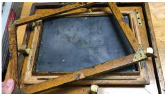
⑩サイクロスタイルの原紙固定は木枠で挟み取り付ける
