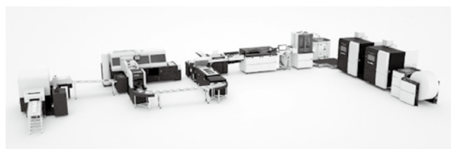
Horizon Innovation Parkに展示される無線綴じ書籍のオンデマンド生産ライン 右端のマシンが SCREEN GA 製 Truepress Jet520HD mono
