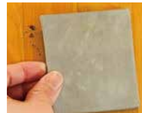
⑪金属板にステンレス金網 100 メッシュを両面テープで 取り付けた簡易ヤスリ
