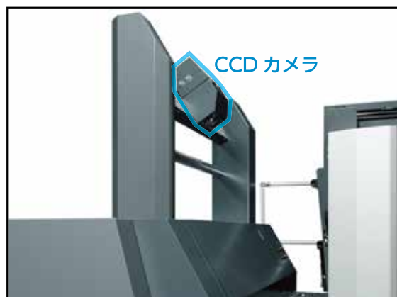
印刷機上の CCD カメラが印刷中の用紙を監視
