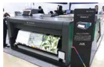
NSK が出展した DIMENSOR S は 基材の発泡効果で凹凸を表現する
