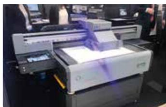
OCEAN の積層型厚盛印刷システム
