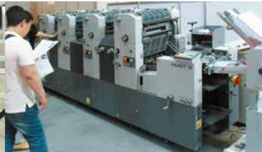
LED-UV 封筒印刷システム
