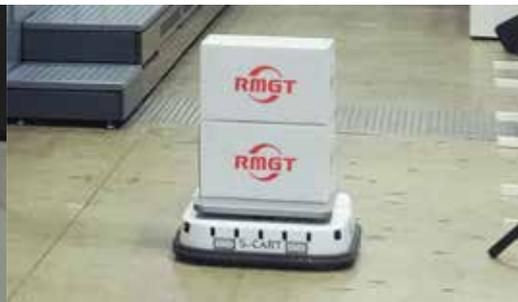
ロボットが次工程へ製品運搬
