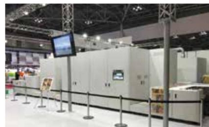
ミヤコシの軟包装パッケージ向けインクジェット機 MJP30AXF は150mの高速印刷
