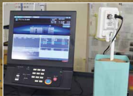
カメラでPODのパネルを監視する工夫も
